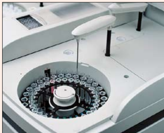
Рис. 1. Автоматический зонд для дозирования реагентов
