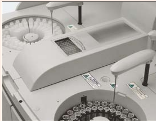
Рис. 3. Рабочая зона, характерная для автоматических биохимических анализаторов среднего и высокого класса
